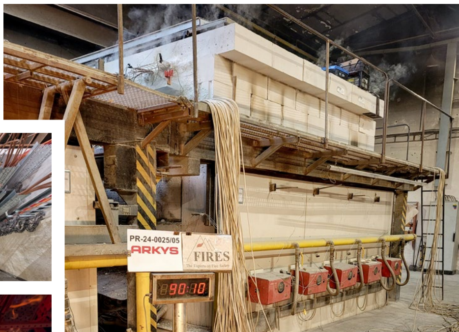
◀ ▶ Zkušební komora ve zkušebně FIRES během zkoušky našich systémů.
